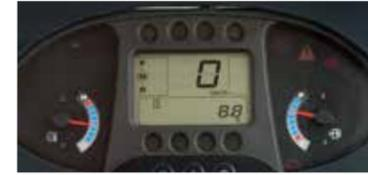
此設備指示液壓油 / 液壓油全流式濾清器 / HST 充油濾清器 / 機油濾清器 / 燃油主濾清器 / 燃油預濾清器 / 後橋油的預定更換時間。
