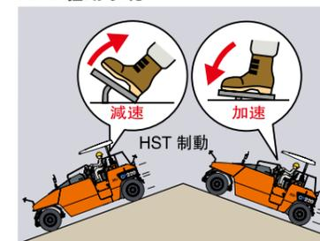
採用HST驅動系統可以使行走平穩。使用加速踏板，CP220就可以像客車一樣平穩起動和停止。
