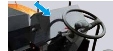
新配備的監視器蓋可以防止故意破壞，以及保護監視器和防止紫外線。
